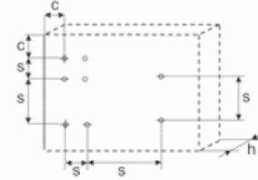
**Charge de service  $F_{s,1}$**  d'un point de fixation<sup>2)</sup> dans la maçonnerie (Températures 50 °/80 °C) pour système non portant/redondant<sup>10)</sup> selon **Guide ATE 020**. Lors du dimensionnement, il convient de respecter les exigences de l'Agrément ETA-07/0121\*\*).
