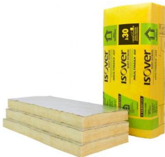
Panneau de laine de verre semi-rigide revêtu d'un surfaçage aluminium : la meilleure performance thermique du marché avec  $\lambda = 0,030 \text{ W/(m.K)}$ . Mise en oeuvre sur tout type de parois, neuf ou rénovation, surtout où l'épaisseur est limitée.
