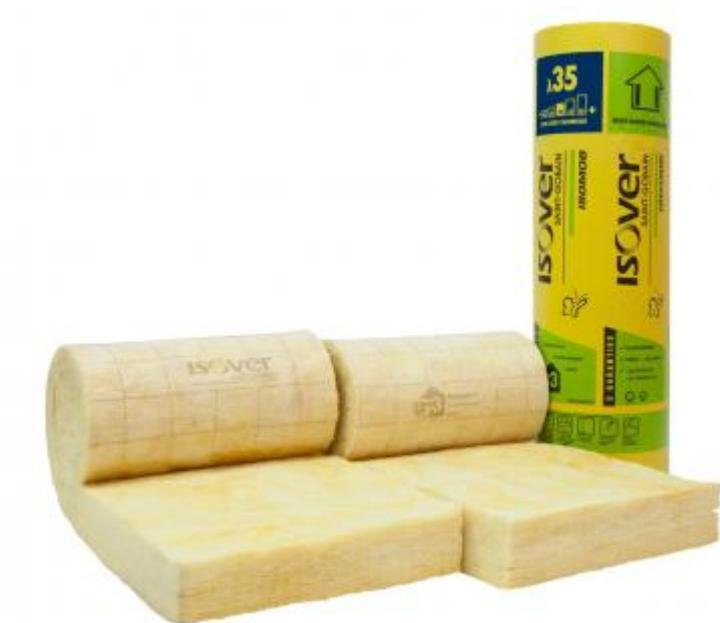
Rouleau semi-rigide en laine de verre à dérouler revêtu d'un voile confort. Prédécoupé aux largeurs standards des entraxes des murs de MOB, il s'intègre sans découpe entre les bois d'ossature.
