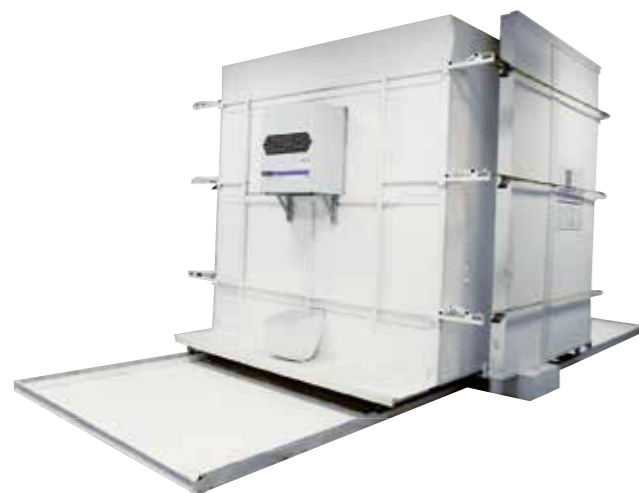
* boîte chaude gardée élaborée chez ATI, en collaboration avec l'ENTPE.
