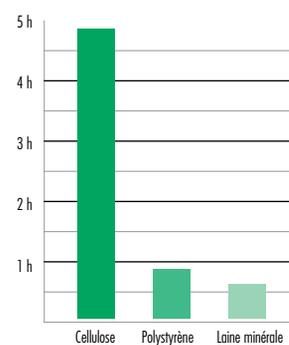
Délai de passage en heures de la chaleur due au rayonnement solaire (= déphasage thermique / PHI) des matériaux isolants.
