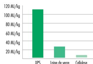
Comparatif de consommations d'énergie primaires nécessaires à la fabrication de matériaux isolants.
