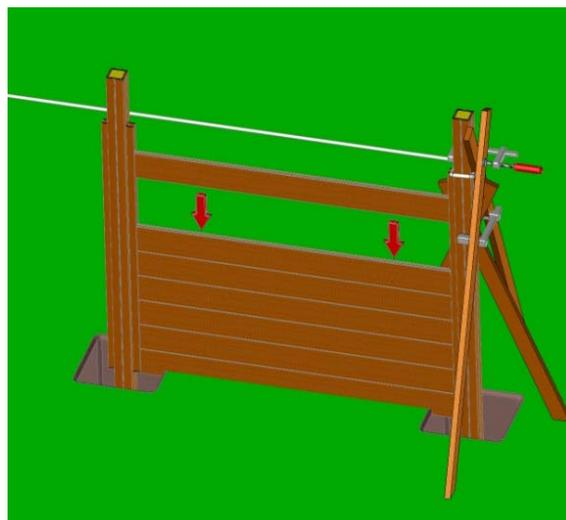
**Dans le cas où votre écran est placé sur un gazon ou sur tout autre sol meuble, assurez-vous que l'écran ne puisse pas s'enfoncer dans le sol. Soutenez le à 3 endroits au niveau du sol au moyen de carrelages, dalle de béton ou autre matériau dur.** La planche du bas est comme cela bien maintenue au-dessus du sol et ne pourra pas s'enfoncer dans le sol au fil du temps.
