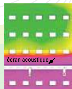
Maillage surfacique d'un terrain naturel réfléchissant AVEC un écran absorbant de 4m de haut.
