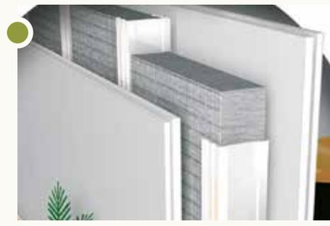
flexCL® épouse aussi sans failles les sections asymétriques et empêche ainsi la formation de ponts acoustiques et thermiques.
