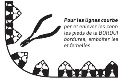
Pour les lignes courbes et les angles, couper et enlever les connecteurs situés entre les pieds de la BORDURE. Pour abouter les bordures, emboîter les connecteurs mâles et femelles.
