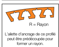
L'ailette d'ancrage de ce profilé peut être prédécoupée pour former un rayon.
