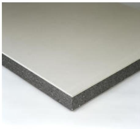
Complexe de doublage constitué d'un panneau isolant en polystyrène expansé (PSE) graphité et élastifié, associé à une plaque de plâtre Placo®. Ancien libellé: Doublissimo® 30 13+100.
