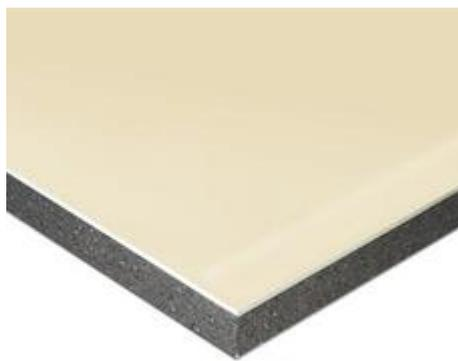
Complexe de doublage constitué d'un panneau isolant en polystyrène expansé (PSE) graphité, associé à une plaque de plâtre Placo®. Parement plaque Placomarine® BA13, à haute résistance à l'humidité.
