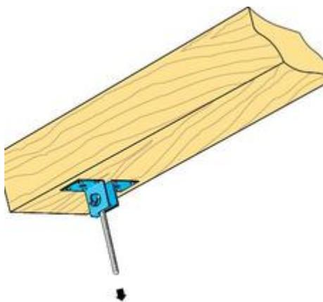
Accessoire de suspension articulé pour plafonds en plaques de plâtre Placostil® F 530 sous plancher bois ou béton
